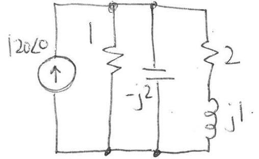
$$S = I_{rms}^* V_{rms}$$
