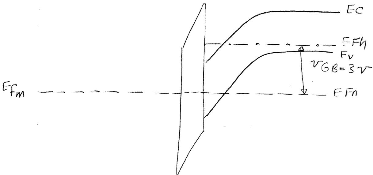
1d) iii)  $V_S = 0$ ,  $V_B = 0V$ ,  $V_G = 0V$ ,  $V_D = 3V$
